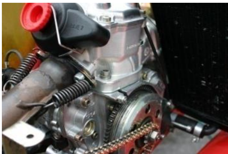
Eingebauter Kart-Motor mit Antriebskette
