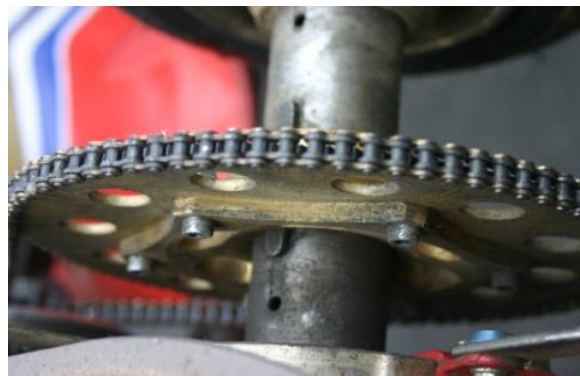
Teile eines Rennkarts – Zahnrad-Antrieb
