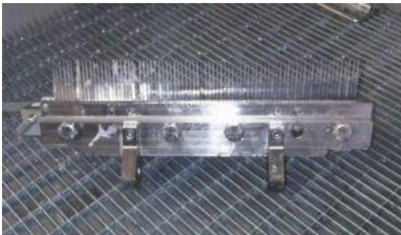
Leimkamm, oben links ungereinigt mit angetrockneten Leimresten
