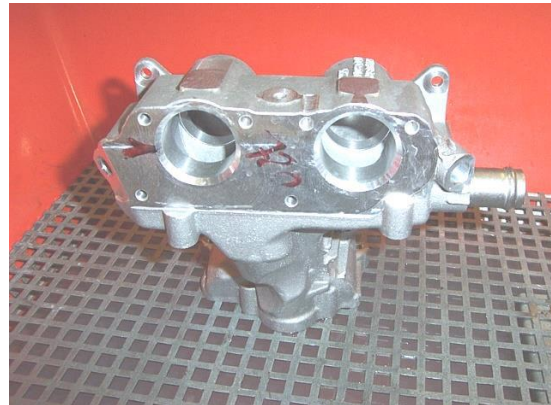
1. Rohkörper vor der Bearbeitung Verschmutzungen in Hohlräumen von außen nicht erkennbar
