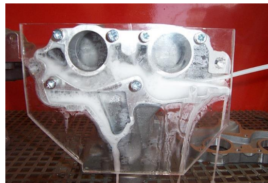
2. Geöffneter Rohkörper mit Makrolonscheibe Reinigung innerhalb des Gusskörpers mit flexibler Düse von rechts
