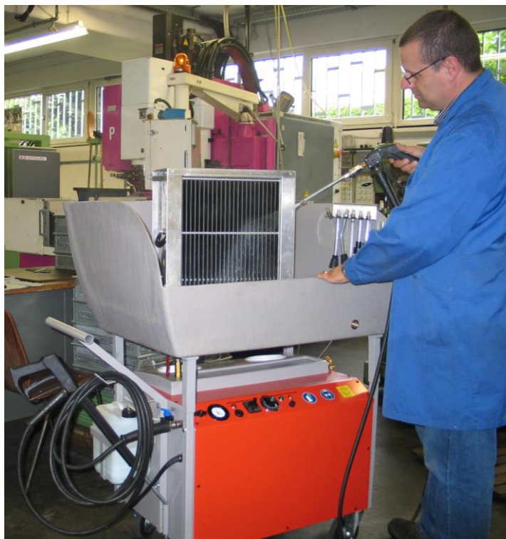
Reinigung eines Elektrostaten in Teilereinigungsebene 1000 SR
