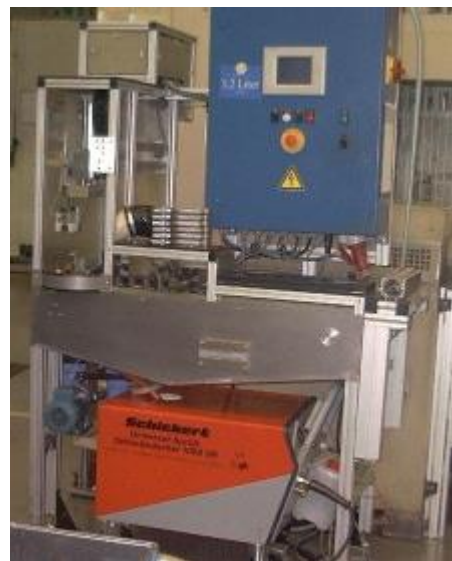
Einfache Teilereinigungs-Anlage auf Basis Niederdruck-Heißreinigungsverfahren.
