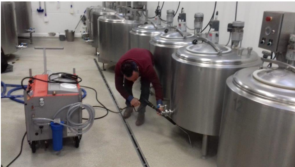
Niederdruck-Heißreinigung mit Knicklanze unter den Eisbehältern. Ideal auch zum Reinigen der Rinnen im Hallenboden.
